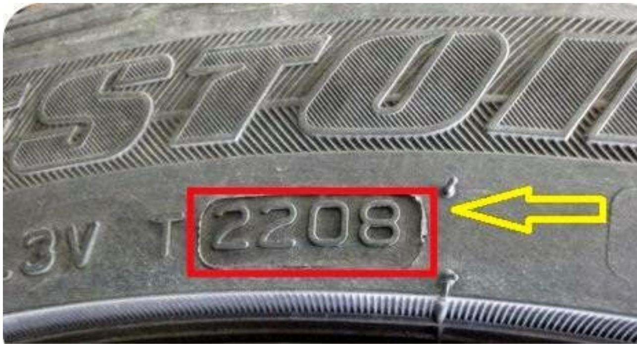
*A imagem acima mostra algum pneu fabricado na semana n. 22 do ano de 2008. Ou seja, em junho de 2013 esse pneu perdeu seu prazo de validade, sendo recomendada a sua troca. Após junho de 2014, a sua rodagem se tornou muito insegura, sendo a data limite para sua substituição independentemente do estado da banda de rodagem*
